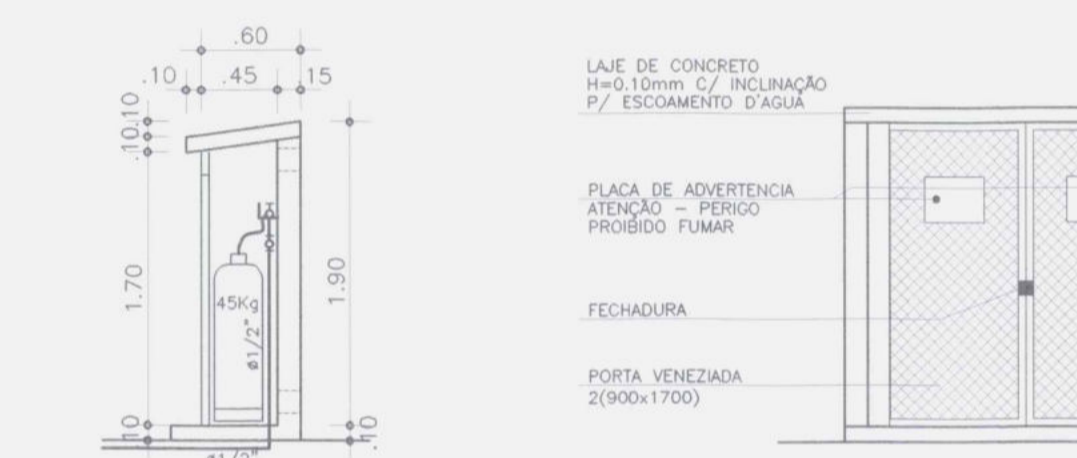
DETALHE 7 - CENTRAL DE GLP ESALA 1:50
